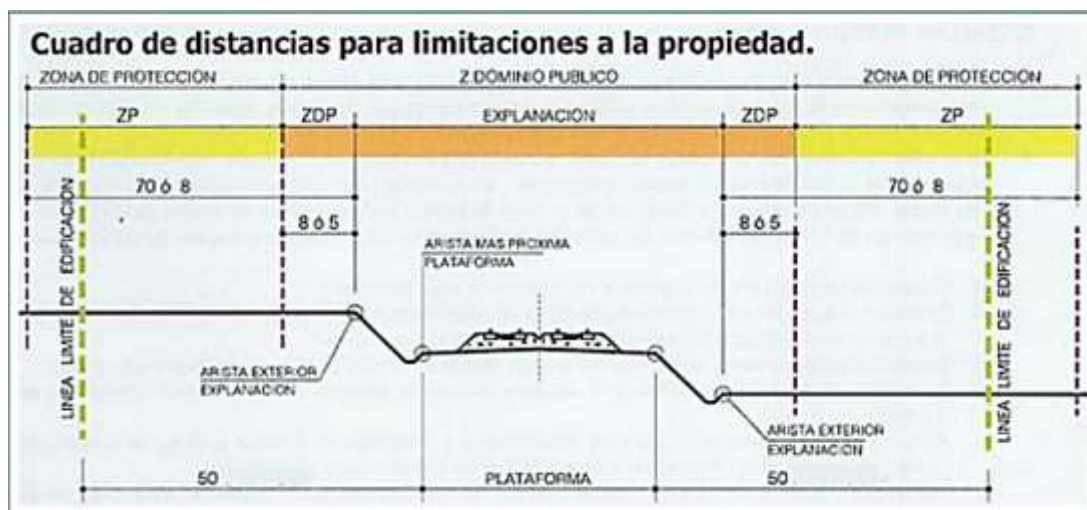
Figura 63. Esquema de zonas de protección relativas a la vía férrea. Cotas en metros.
