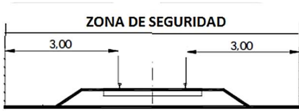
Figura 62. Esquema de zona de seguridad de línea férrea.
