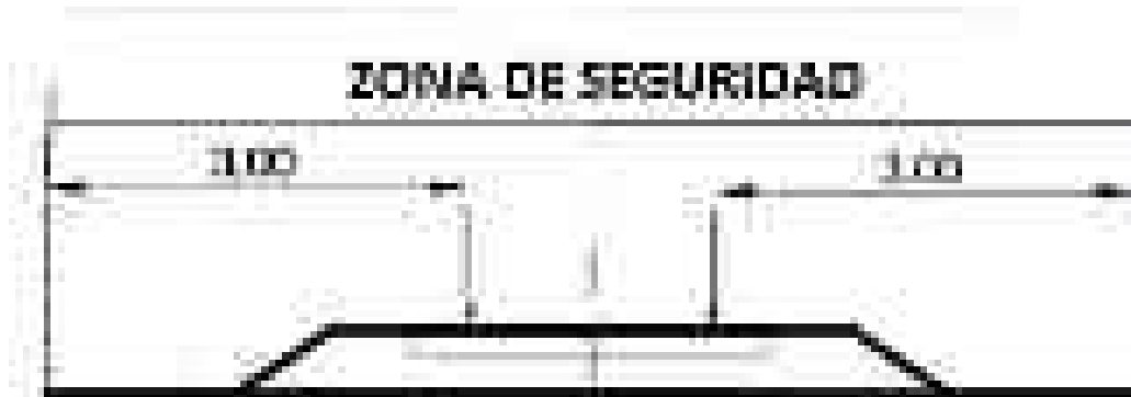
Figura 62. Esquema de zona de seguridad de línea férrea.
